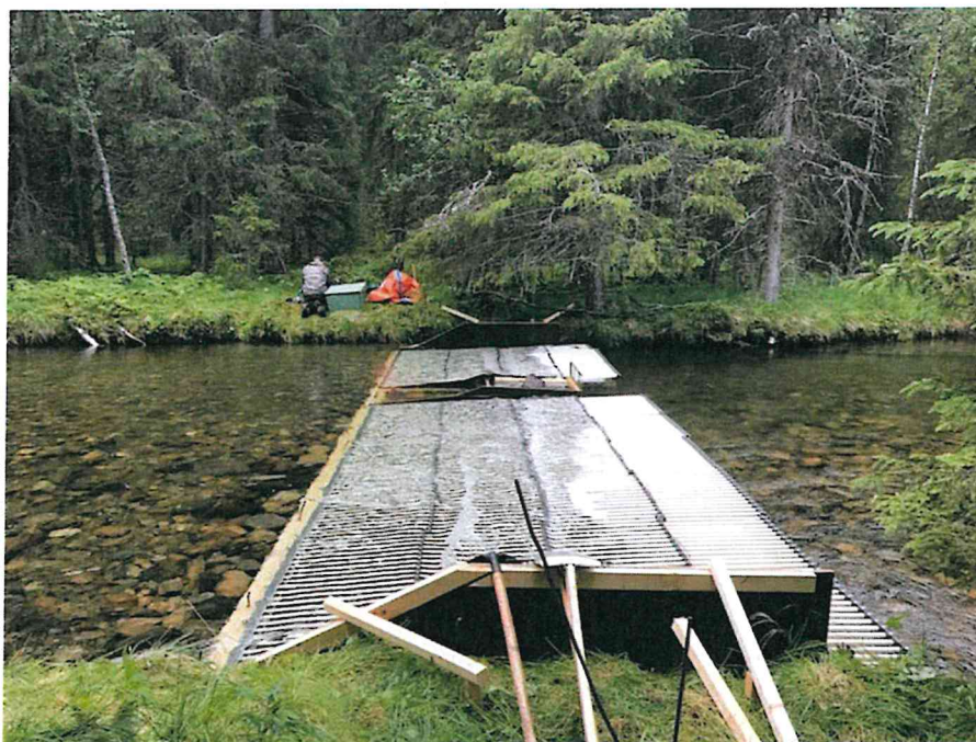
Figur 20. Ledgaller av typen "resistace board weir" med central placerad fiskräknare från Våleån, Jämtland. Foto: Anders Dahlén. Länsstyrelsen i Jämtlands Län.
